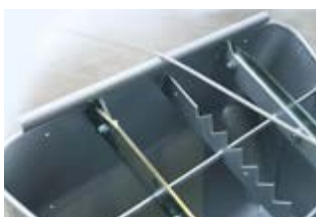
Verschleißschiene für Beschickerkante
