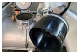
Trichteraufsatz für Styroporsäcke, mit Gummikranz, leicht klappbar
