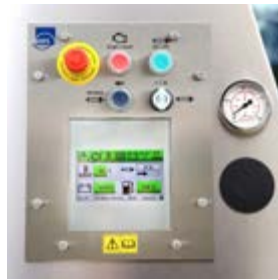
Display – durch Panzerglas geschützt
