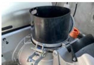
Trichteraufsatz für Styroporsäcke, mit Gummikranz, leicht klappbar
