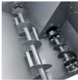
Zusätzliche Rührwelle im 400 Liter Förderbehälter
