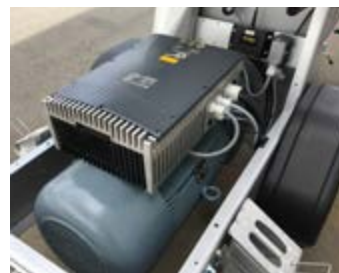
Der 22 kW Elektromotor
