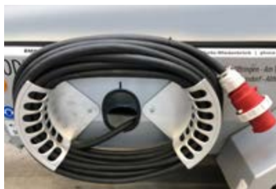
Kabelhalter zum einfachen Aufrollen des Zuleitungskabels.
