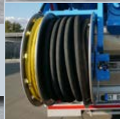
Schlauchabroller (hydraulisch) im Heck positioniert.
