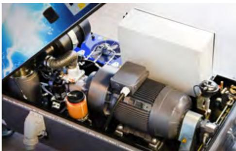
Der frequenzgesteuerte 30 kW Elektromotor
