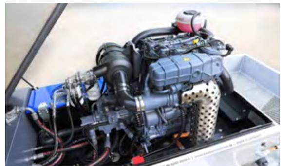
DEUTZ TD 2.2 Motor mit Hydraulik-Einheit
