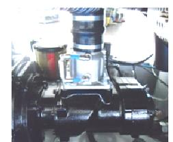
Schraubenverdichter mit Reglereinheit
