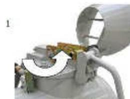
Der Kesseldruck entweicht über das Entlüftungssystem und wird durch den Entlüftungsschlauch zum Boden abgeleitet.
