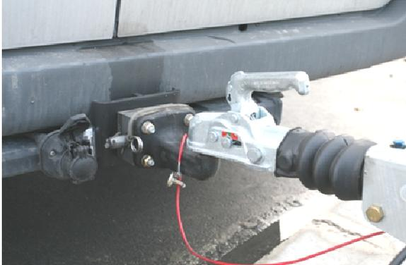
Beim Bremsen des Zugfahrzeuges bzw. Bergabfahrten schiebt die Zugstange der Auflaufeinrichtung sich, je nach Größe der Deichselkraft, ein. Dadurch spricht die Bremse an.
