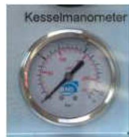
Wenn das Kesselmanometer Druck im Kessel anzeigt, den Kessel manuell entlüften.
