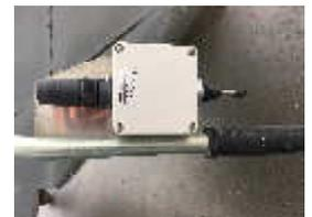
Nach Arbeitsende die Schrapperschaufel vom Stahlseil trennen und mit dem Daumenschalter das Seil aufrollen lassen.
