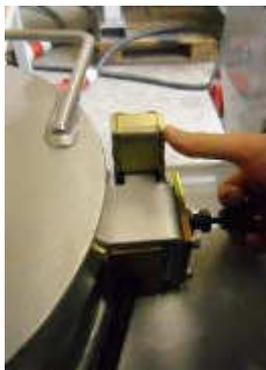
Zum Abnehmen muss der Knebel am Schalter herausgezogen und der Sicherungshebel nach hinten gekippt werden (siehe Bilder rechts).
