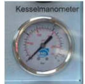
Wenn das Kesselmanometer Druck im Kessel anzeigt, den Kessel manuell entlüften.
