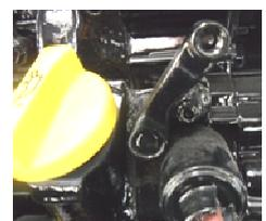
Den Hebel nach links drücken bis der Motor aus ist.
