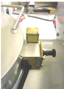
Nockenschalter mit Sicherung
