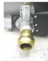
Anschluss Förderschlauch am Misch- und Förderkessel
