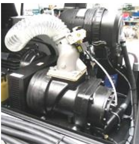
Schraubenverdichter mit Ansaugfilter und Ansaugregelung
