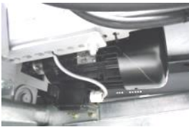
Antriebsmotor Mischer (unter dem Fahrgestell)
