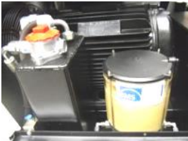
Hydraulik (links) Automatische Fetteinrichtung (rechts)
