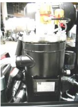
Ölabscheider (mit rechts dem Ölfilter)
