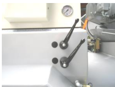
Ober- und Unterlufteinstellung
