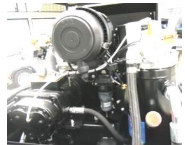
Schraubenverdichter und Öl-Separator
