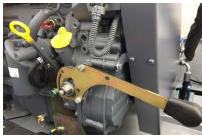
Ручное управление часотой вращения двигателя
