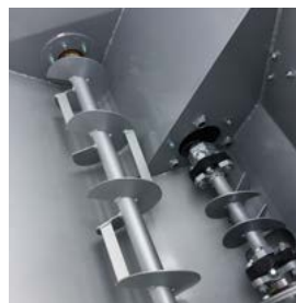
Дополнительный вал мешалки в контейнере
