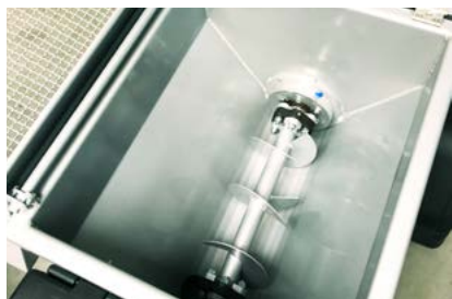
Две дисковые муфты обеспечивают плавное вращение
