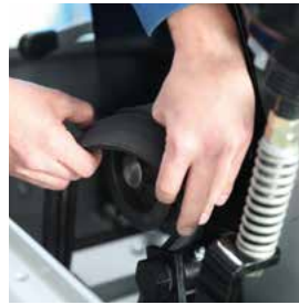
Einfacher Riemenwechsel am Mischwerk
