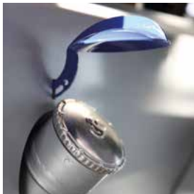
Tankeinfüllstutzen außen für einfaches Betanken
