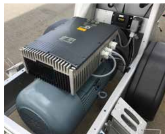
Der 22 kW Elektromotor
