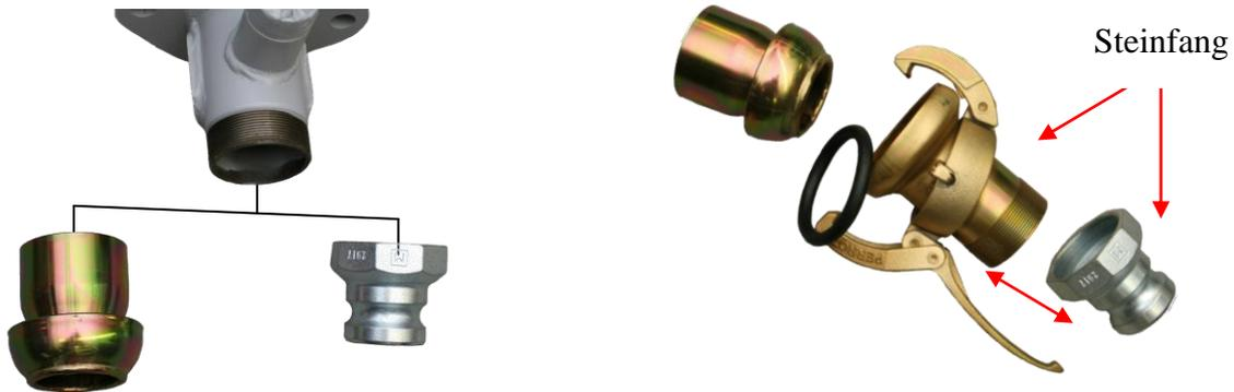
Zur Anpassung bei kleinerem Durchmesser des Förderschlauchs an den Kesselabgang kann ein Steinfang verwendet werden. Steine größerer Körnung werden im Steinfang zurückgehalten, dadurch wird ein Verstopfen der Förderleitung verhindert.
