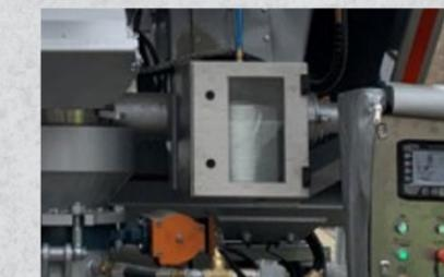
**Häcksler**, um Glaserfaser-Rohlinge zu schneiden. Schneidkopf 4.000 U/min. Artikel-Nr. 15511
