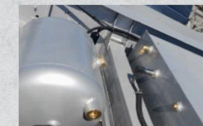
**Druckluftbehälter** 60 Liter Volumen, zusätzlicher Druckluftanschluss am Heck Artikel-Nr. 15319
