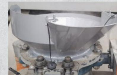
**Trichter für Beuteinwurf**, Pulvermaterial kann mühelos zugeführt werden. Artikel-Nr. 14797
