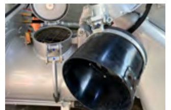
Trichteraufsatz für Styroporsäcke, mit Gummikranz, leicht klappbar
