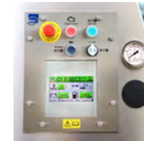
Display – durch Panzerglas geschützt
