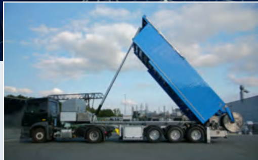
Système basculant pour chape fluide. Le TITAN F. Technique compacte de la machine, des performances élevées.
