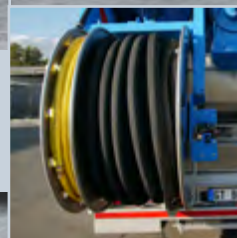
Dévidoir de tuyau (hydraulique) positionné à l'arrière.
