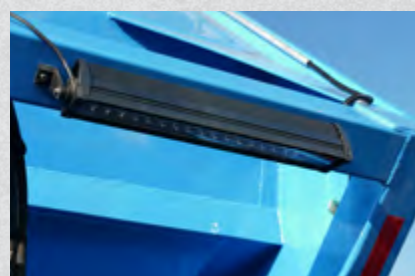
Grand projecteur de travail à LED pour les séries Z et F (en série).
