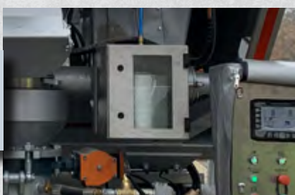
Boîte pour rouleau de fibres à hauteur d'opérateur pour la série Z.
