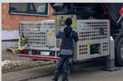
Ce TITAN Z est équipée d'un double malaxeur – permettant un convoyage continu.
