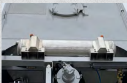
Réservoir d'eau agrandi de 250 l mont à l'arrière.
