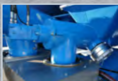
Malaxeur étanchéifié par des anneaux en caoutchouc.
