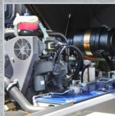
44,5 kW DEUTZ-Dieselmotor der neuesten Generation, Stage V.
