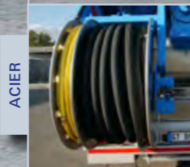
Dévidoir de tuyau (hydraulique) positionné à l'arrière.
