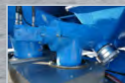
Malaxeur étanchéifié par des anneaux en caoutchouc.
