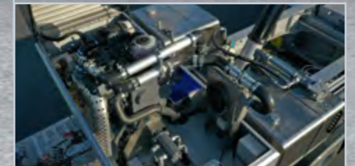
Moteur diesel DEUTZ de 44,5 kW de dernière génération, Stage V.
