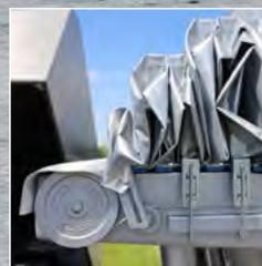
Das stabile Schiebe-verdeck ist elektrisch angetrieben, lässt sich zum Beladen leicht öffnen und schließen.
