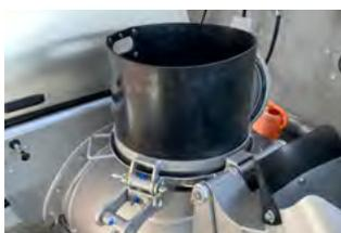
**Trichteraufsatz** für Styroporsäcke, mit Gummikranz,
