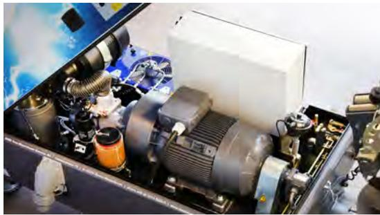
Der frequenzgesteuerte 30 kW Elektromotor
