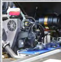
Nach dem Vorbild der neuen alpha CR-Serie mit 44,5 kW DEUTZ-Dieselmotor. Mit BMS-Kühlsystem – mehr Kühlleistung über zwei hydraulische Lüfter. Luftleistung bis 6 m<sup>3</sup>/min. bei 7 bar.
