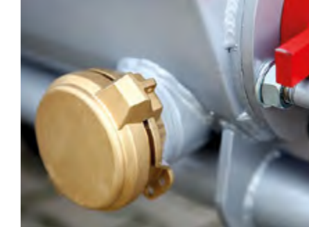
Large ouverture de purge
