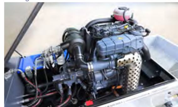
Moteur DEUTZ TD 2.2 avec unité hydraulique
