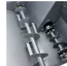
Arbre d'agitation supplémentaire dans le Réservoir de 400 litre
