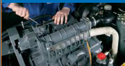
4-цилиндровый дизельный двигатель с мощностью 48,5 кВт.
