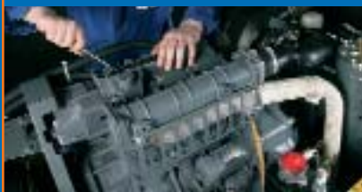
Le moteur quatre cylindres d'une puissance max. de 48,5 kW
